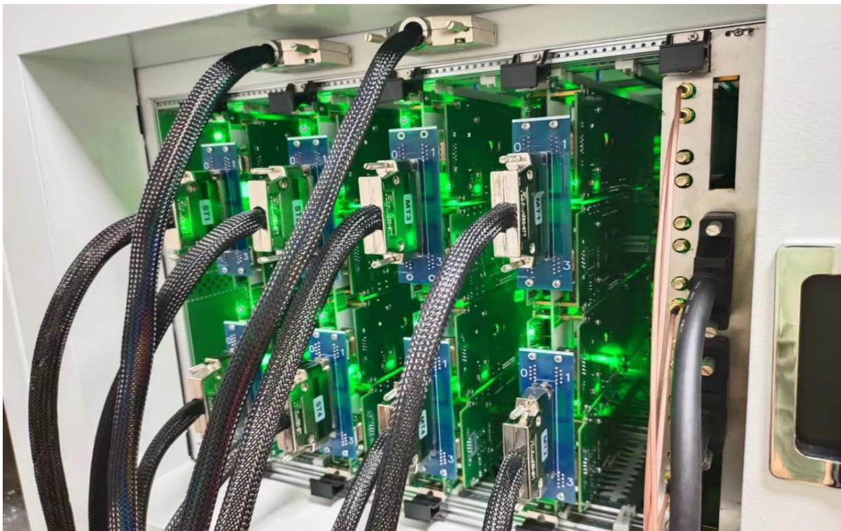
图 1-2 资源集线器(测试头)实物图
